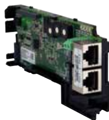
Volitelná karta sítě EtherNet/IP pro dva porty podporuje kruhové topologie s funkcionalitou DLR
