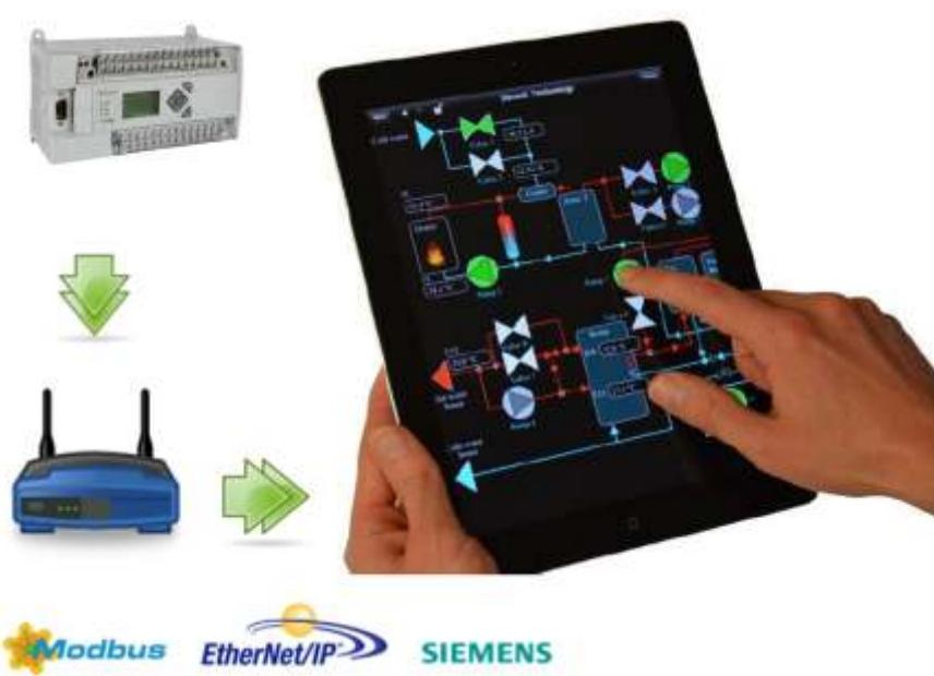
Je podporována široká škála běžně používaných průmyslových protokolů, což umožňuje připojení nejrůznějších sensorů a I/O zařízení
